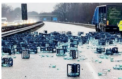
Unfall auf der Autobahn wegen mangelhafter Ladungssicherung. Bild: © Polizei Verden/Osterholz.
